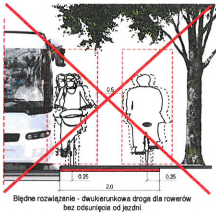
SCHEMAT 12. Błędne usytuowanie dwukierunkowej drogi dla rowerów bez zachowania skrajni od jezdni.
